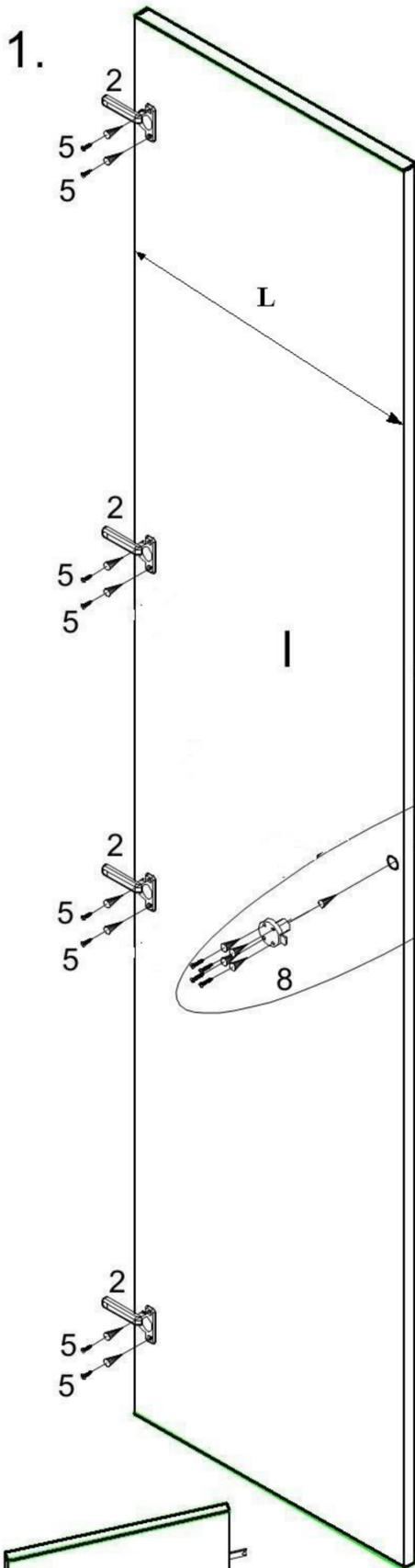
Просверлить отверстие в двери под замок диаметром 20мм. Высота отверстия выбирается индивидуально. Размер до присадки от края двери до центра составляет 55мм (для дверей L-352мм размер составит 27мм) .
