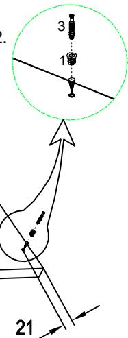
2. Закрепить столешницу к каркасу стола
